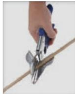
Winkelverstellbare Gehrungsschere, beidseitig verwendbar, feine Trapezklinge, auswechselbar, Gehrungsschere zum Schneiden von Kunststoffprofilen, Glas, Gummidichtungen, dekorativen Leisten, Fliesenabschlußleisten, PVC-Leisten usw. Schnitttiefe 60 mm, **Ersatzklingen:** Art.-Nr. EKM61, EKMA, 10504240
