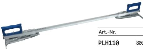
mit extra großer Spannweite, für Platten mit einer Stärke bis zu 12 mm, besonders geeignet zum Verlegen mit geringen Fugenabständen, Backenstärke 2 mm - ergibt eine Fugenstärke von ca. 2,5 mm, ergonomischer Handgriff, bis 30 kg
