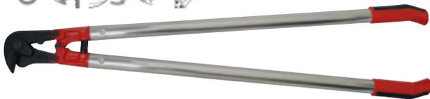
ca. 40 % leichter durch hochfestes Leichtmetall-Griffpaar, kleiner Öffnungswinkel der Griffe, geringer Trennkraftaufwand, problemloses Greifen flach liegender Baustähle, Messer- und Rohrkopf aus Spezialstahl, nachstellbare Messer, Begrenzungsanschlag mit extra großer Pufferzone, gesenkgeschmiedet, Deutsches Patent,
