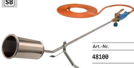
mit Sparflammengriff zur Energieeinsparung, Ablegeständer, für handelsübliche 5-, 11- und 33 kg Propangasflaschen, Druckregler: unbedingt erforderlich für Propangasflaschen (zum Beispiel Art.-Nr. 52114),
