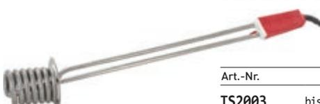
hochwertiger Rohrheizkörper aus Edelstahl, wärmeisolierter Griff mit Abstandhalter für einen sicheren Betrieb, Überhitzungsschutz, Kabel mit Knickschutzdülle, für bis zu 5 l Wasser, Leistung: 2000 Watt, Maße: 6 x 6 x 45 cm,
