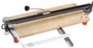
25 cm breite Holzplatte, untere Brechvorrichtung, Tragegriff im Holzbrett, geschliffene Führungsschiene, stabiler Seitenausleger, Anschlagwinkel ausziehbar, 4 stabile GummifüÙe, inkl. 20 mm HM-Rädchen,
