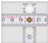
aus Buchenholz, Gliederstärke 3,0 mm, Gliederhöhe 16 mm, Gliederzahl 10, innenliegende durchgenietete Gelenkfedern aus standfestem Kunststoff, Winkerteilung in der Gelenkverbindung des ersten Maßstabgliedes, durch die eingelassenen Gelenke entsteht im ausgeklappten Zustand eine durchgehend gerade Kante, weiße Lackierung, 2m Länge mit Duplex-Teilung.
