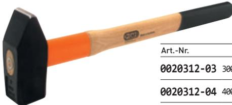
**DIN 1042**, Kopf schwarz pulverlackiert, korrosionsgeschützt, aus legiertem Spezialstahl, sorgfältig gehärtet und angelassen, Kopf und Stiel mit Ringkeil befestigt, gehärtete Stielschutzhülse, Bahn geschliffen, Kanten sauber gebrochen, Hickorystiel
