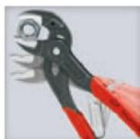
patentiert, DIN ISO 8976, Chrom-Vanadin-Elektrostahl, geschmiedet, ölgehärtet, Zange grauatramentiert, Kopf poliert, Griffe mit rutschhemmendem Kunststoff überzogen, Einhandbedienung für Links- und Rechtshänder, optimal für häufiges Umgreifen, schlanke Bauform, für Muttern: SW 10 - 36 mm für Rohre:  $\varnothing$  1/8" - 1 1/4"
