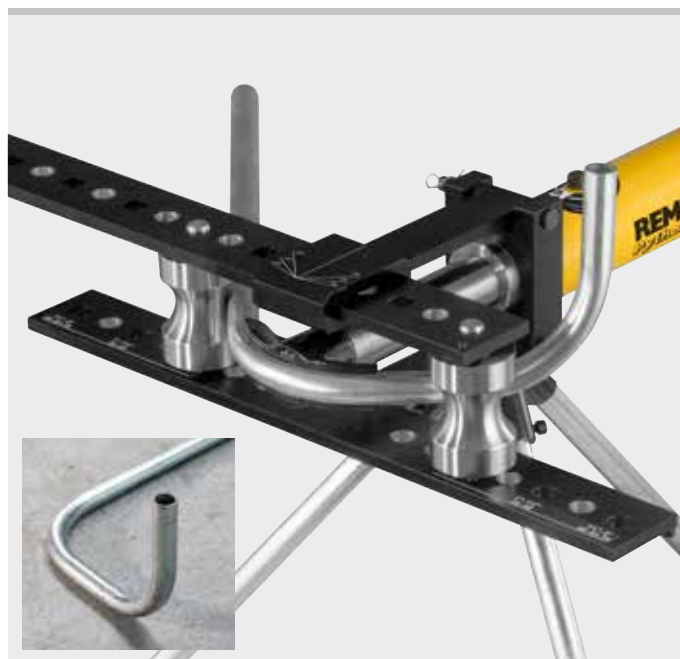
Odskok (etážový ohyb) ve více rovinách.
