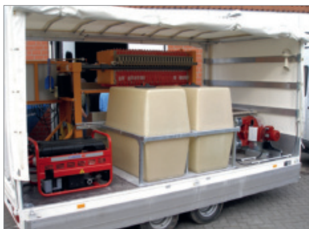
Von links: Stromerzeuger, Klarwassertanks, Schlamm-pumpe
